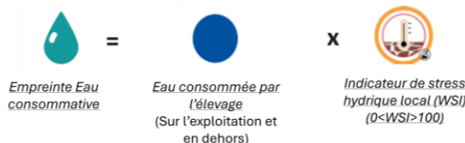
Figure 2 Définition de l'empreinte « eau consommative » répondant à la norme la norme ISO 14046
